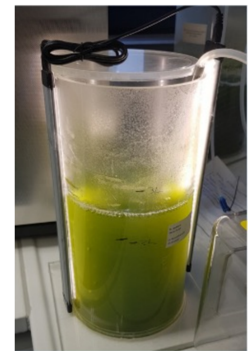
Abb. 2: Blasensäule zur Kultivierung der Mikroalge Microchloropsis gaditana
